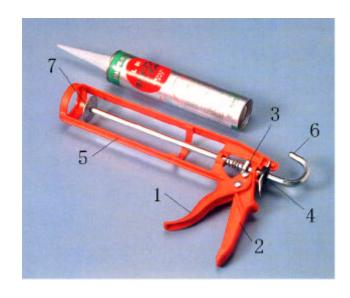
力強い引き = 引き易い ハンドルと引き金の形状 = 快適に使えます パントルと引き金のが状 - K過に使えより 精巧な硬質クラッチ板 = 長時間の使用に耐えます 圧抜き機構 =シ・ラントのタレ止め ガラス繊維強化ナイロン製 引っかけホック = 便利 亜鉛メッキ鋼 = 腐食に耐える
